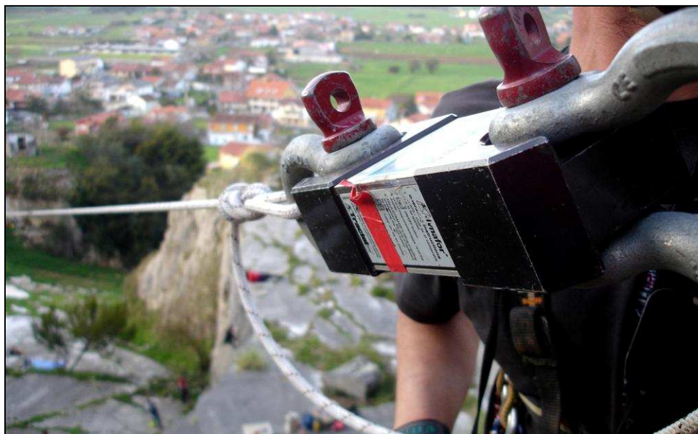
El dinamómetro se encontraba situado en la parte superior de la instalación. En una tirolina ambos puntos de anclaje soportan aprox. la misma carga (equilibrio estático)
